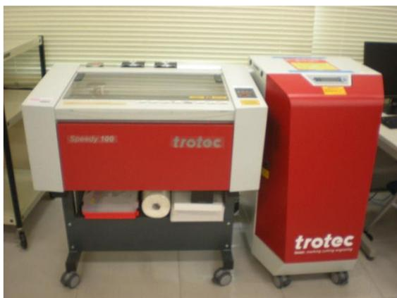
図5 レーザー加工機
