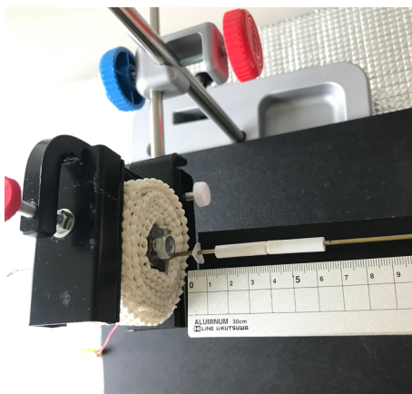
図 31: 棒に平行に定規を設置し、上方からデジタルカメラで動画を撮影した。
