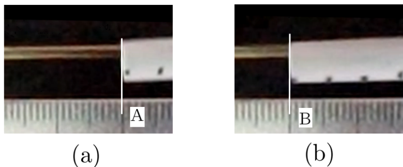
図 32: 棒に平行に定規を設置し、基準線 A、B に接したストローの静止画。(a) 左方向に移動するストローで、基準線 A に接したフレーム。(b) 左方向に移動するストローで、基準線 B に接したフレーム。
